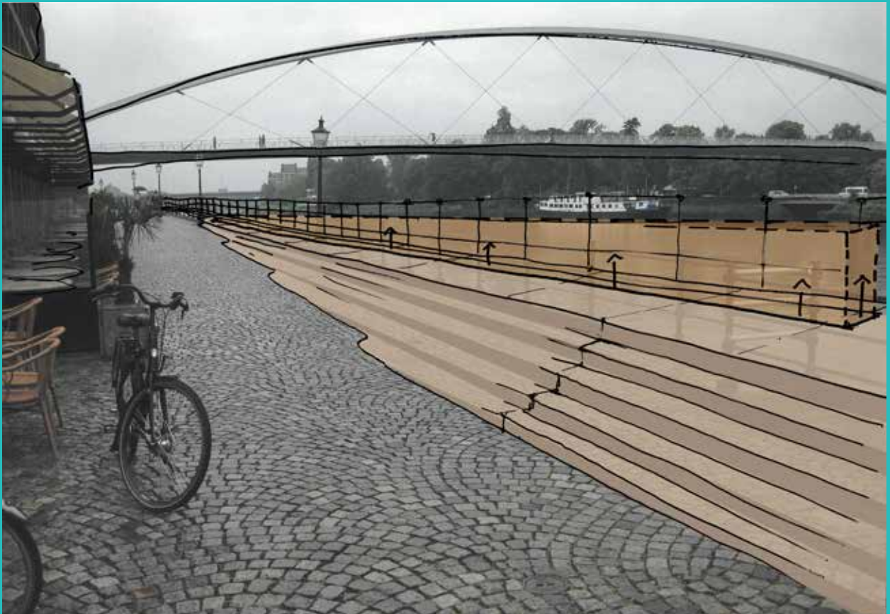
Een combinatie van ophoging van de kade met een trappartij en een opdrijvende waterkering ofwel een keermuur.
